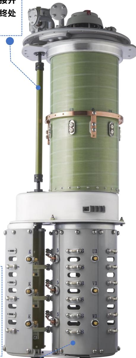
转换触头全部采用滚动设计，磨损小，铜钨材质的触头，确保在真空管因漏气或绝缘下降不能可靠熄弧时，其在一定次数内可开断电流，从而避免级间短路。
