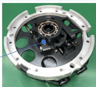
快速机构采用并列压簧机构，用齿轮齿条把机构转角增大，满足切换开关各触头间配合时间的充足。
